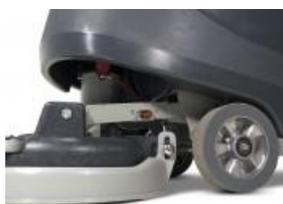
La TGB6055T intègre un flexible de vidange extensible pour les eaux usées. Elle est munie également d'un bouchon de remplissage intégrant un flexible extensible flexifill. Réservoir de 60L permettant une grande capacité de stockage.
